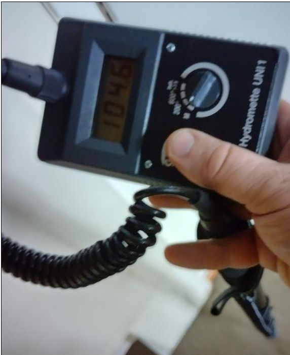
Kuva 4. Pintakosteudenilmaisimen näyttämä 104.6 tilassa 21.
