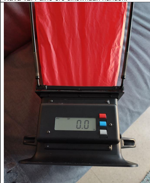
Kuva 14. Poistoilmamäärä oli olematon useissa mittauspisteissä.
