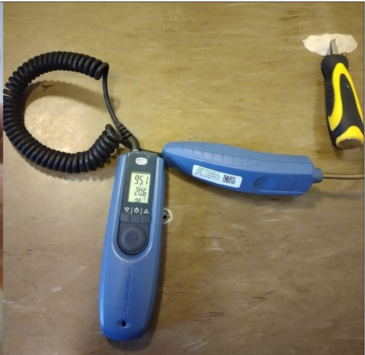
Kuva 5. Sama kohta tilassa 21, RH lattiapäällysteen alla oli 95.1 %.
