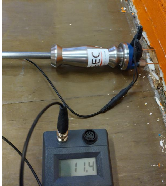
Kuva 8. Alaohjauspuun kosteuspuiteisuus oli 11.4 p-% muutaman sentin syvyydellä. Arvo on normaali.
