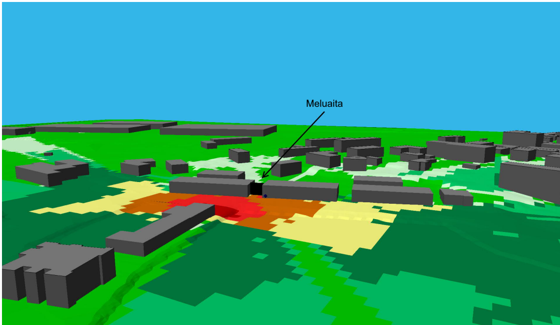
Kuva 14. Meluste sijoitettuna kahden makasiinirakennuksen väliin.
