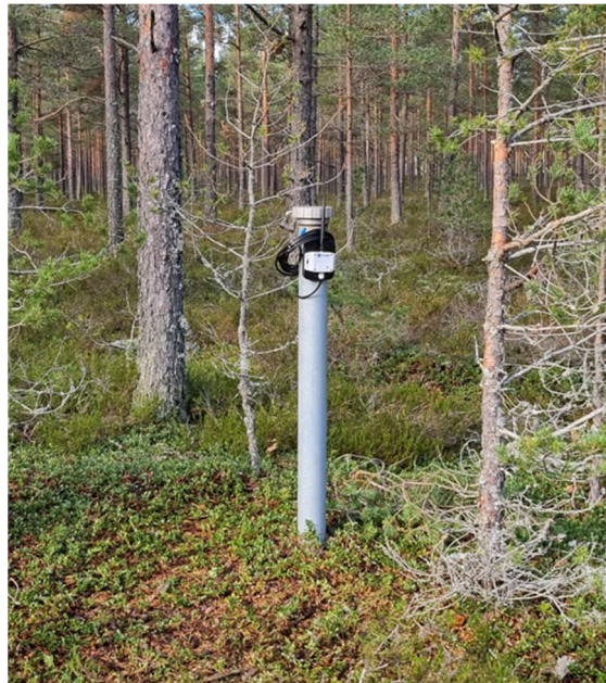
Kuva 1/Bild 1. Jatkuvatoiminen pinnanmittaus havaintoputkessa/Kontinuerlig ytmätning i observationsröret
