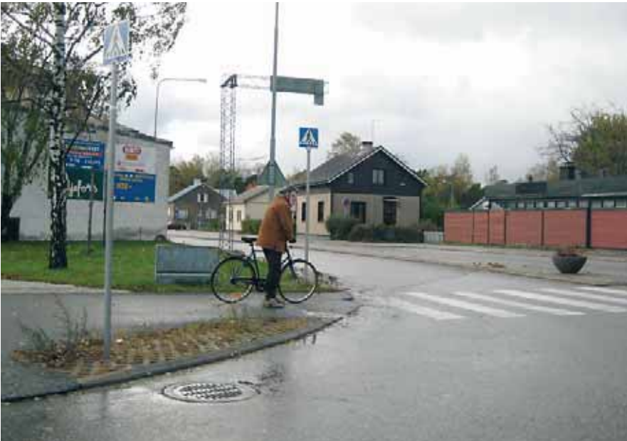
Kuva 6.6 Talo näkemäesteenä Esplanaadin ja Santalantien liittymässä.
