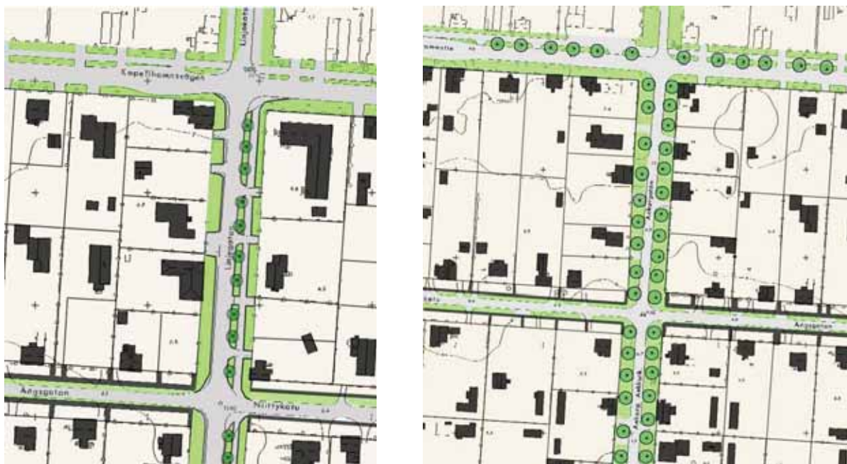
Linjegatans nya lättrafikled mellan Kapellhamnsvägen och Ängsgatan. Ankargatans och Kapellhamnsvägens breda gaturum struktureras om med hjälp av grönanläggningar.
