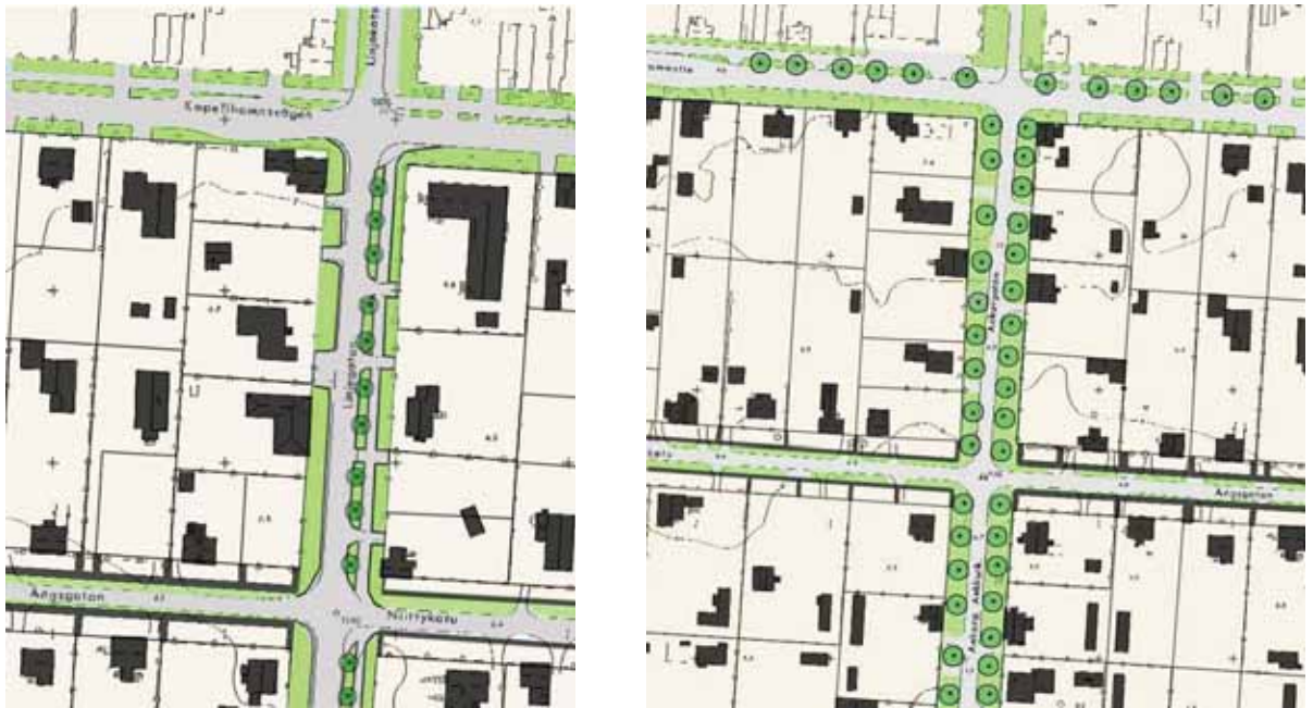
Linjakadun uusi kevyenliikenteenväylä Kappelisatamantien ja Niittykadun välillä. Ankkurikatun ja Kappelisatamantien leveää katutilaa jäsenetään viherrakentamisen keinoin.
