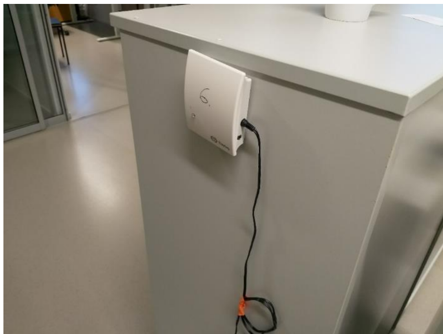
Esimerkkikuva. Sisäilman hiilidioksidipitoisuusmittaus (FCG Oy).
