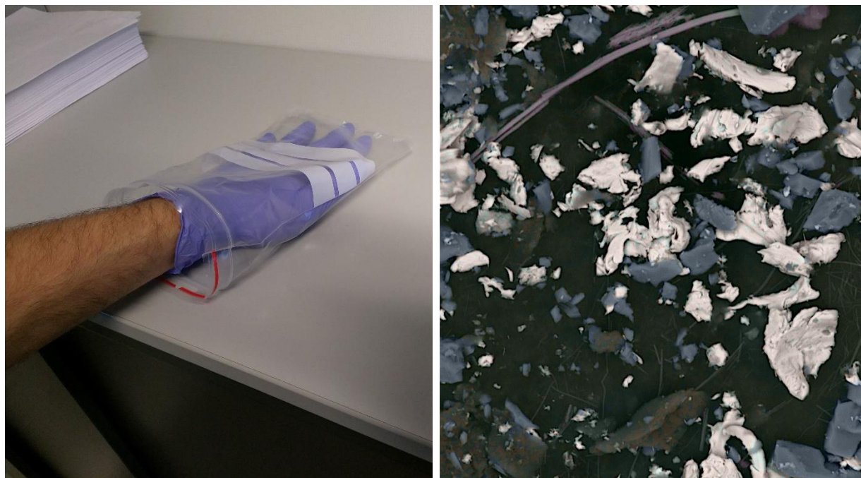
Esimerkkikuva. Vasemmalla pölynäytteenotto ilmanvaihtokanavasta (FCG Oy). Oikealla näytteen koostumuksen analyysi elektronimikroskoopilla (Mikrofokus Oy).
